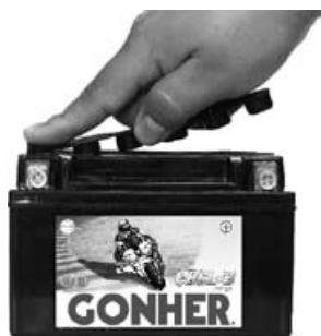
**NOTA:** Con este procedimiento se completa el llenado de la batería, por precaución, NUNCA RETIRE LA TIRA DE TAPAS.
